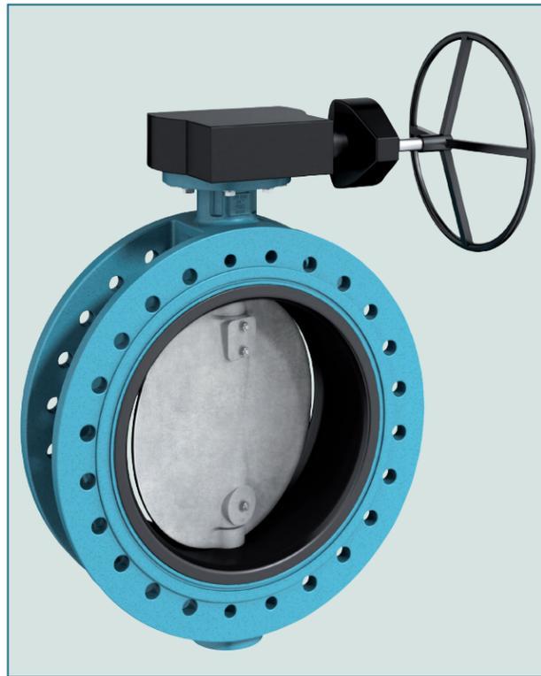
Двухфланцевый затвор с эластомерным уплотнением для применения на высоком давлении. Завулканизированная манжета и односоставной вал позволяют использовать затвор на рабочем давлении до 25 бар.
