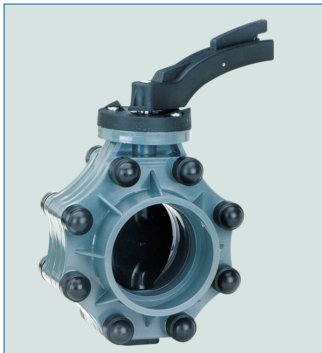
Пластиковый поворотный затвор К 016 DN 100 с растровой ручкой.
