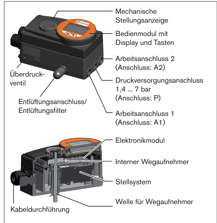
Bild 1: Aufbau Typ EP 501/EP 501 C
